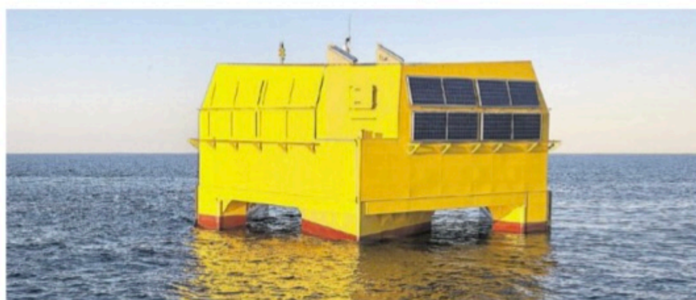
Au large du Croisic (Loire-Atlantique), le prototype Wavegem produit de l'électricité.
