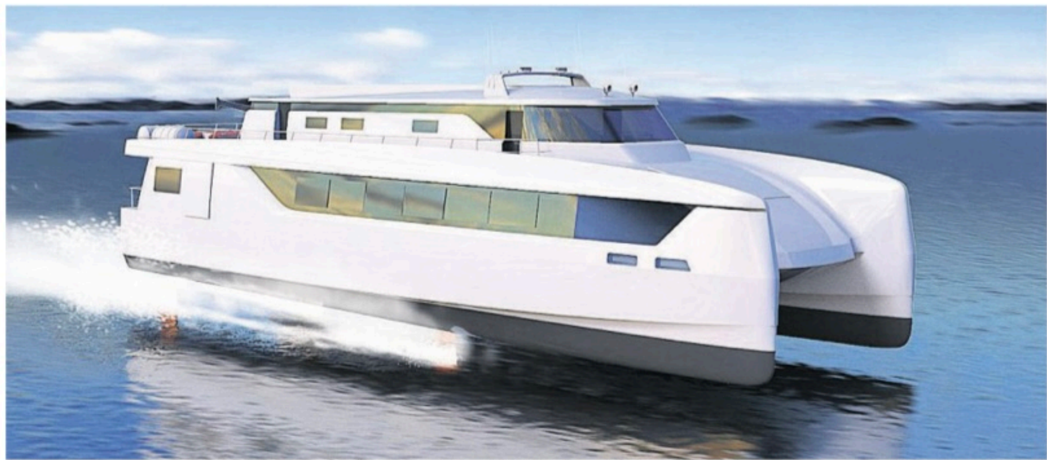
Un bateau de transport de passagers sur foils ? Le cabinet VPLP l'a imaginé, inspiré par les prouesses des voiliers de la course au large, qui volent sur l'eau grâce à ces appendices.
